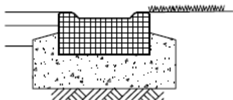
Рис. 3.3.3.3a: Открытый водосточный жёлоб, изготовленный из бетона или из полимербетона на полиэфирной смоле.
